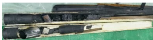
图23 电容器解剖后内部情况
