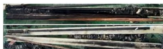
图 16 电容器解剖后内部情况
